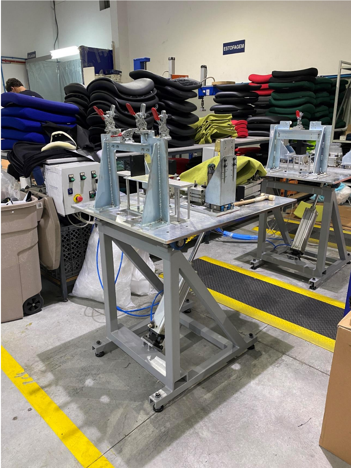
Figura 2: Máquinas automáticas de aplicação de rede
